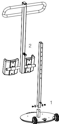
TurnSafe besteht aus drei Teilen und lässt sich für Aufbewahrung und Transport einfach zerlegen.
