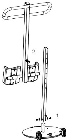
TurnSafe består av tre delar som lätt kan nedmonteras för förvaring och transport.
