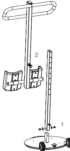
TurnSafe è suddiviso in tre sezioni che possono essere smontate facilmente per semplificare il trasporto e l'immagazzinaggio.
