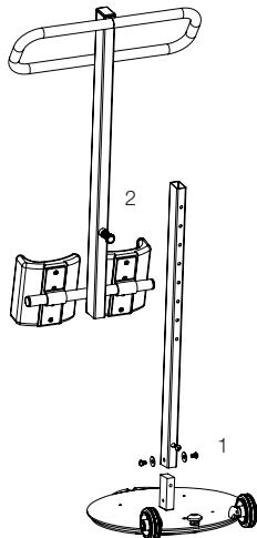
TurnSafe se compose de trois parties démontables facilement pour rangement et transport.
