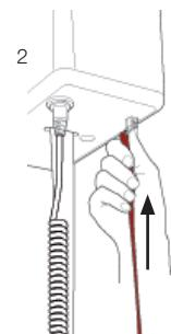
Bei elektrischer Notabsenkung wird das Liftband so lange ausgefahren, wie die Not-Aus-Leine gezogen wird. Beobachten Sie den Lifter und den Pflegebedürftigen während des gesamten Bewegungsablaufs. Andernfalls, oder falls sonst erforderlich, ist die elektrische Notabsenkung abzubrechen. Achten Sie immer darauf, dass die Notabsenkung auf einen geeigneten Platz erfolgt.
