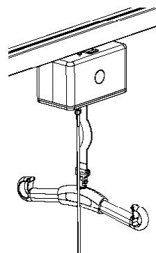
RiseAtlas stoppt automatisch, wenn das Liftband nicht belastet wird, z. B. beim Absenken des Hebebügels auf ein Bett. In diesem Fall muss das Liftband zuerst belastet werden, um ein Auf- oder Abfahren zu ermöglichen.
