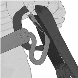
Bei der Wahl der Bandschlingen ist der kürzest mögliche Abstand zum Bügel der Umsetz-/Aufstehhilfe zu wählen.
