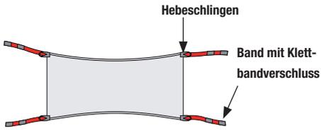
TurningSling besteht aus einem strapazierfähigen Einwegmaterial mit je zwei Hebeschlingen und zwei Bändern mit Klettbandverschluss an den Kurzseiten.
