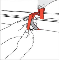
Das Band mit Klettverschluss durch die Hebeschlinge ziehen und Klettverschluss befestigen.
