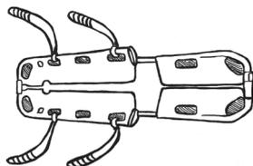
Les sangles se montent à raison de deux de chaque côté du brancard, puis sur l'étrier de levage. Pour lui éviter tout désagrément, adapter la largeur de l'étrier de levage en fonction du patient.
