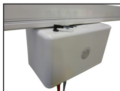
Bild 5; Kablet fra løbekatten kobles ind kobles ind
