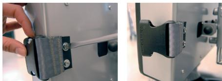
Visser les boucles de Calfstrap sur la face arrière de l'appui pour les genoux de MiniLift125/MiniLift200. Placer les rondelles fournies entre le cuir et la vis.
